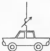
Рис. 15.6. Настройка укороченной вертикальной автомобильной антенны с помощью переменной индуктивности
