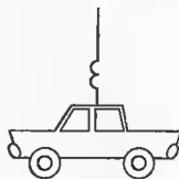
Рис. 15.4. Вертикальная антенна с удлиняющей катушкой
